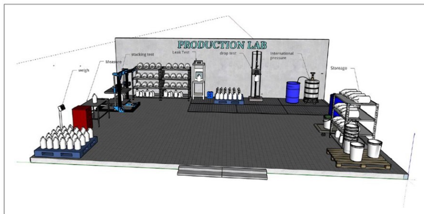
ห้องทดสอบ Performance สำหรับทดสอบถังบรรจุภัณฑ์
